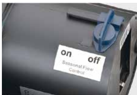
SFC-schakelaar: Bij AquaMax Eco Premium 12000/16000/20000. Bij ingeschakelde SFC-functie zorgt de pomp zelfstandig voor de optimalisering van de waterhoeveelheid en de opvoerhoogte en reduceert deze tot max. 50%.
