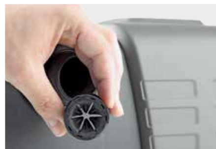
Automatische bypass-regeling: Het geïntegreerde bypass-membraan regelt de waterverdeling volautomatisch aan de hand van het stromende water, en past zich zo aan de wisselende omstandigheden aan, bijv. aan het Seasonal Flow Control-systeem
